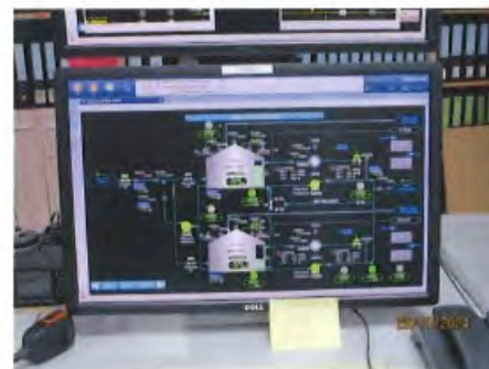
ภาพที่ 2-46 ระบบ DCS และ Flow Control Valve ควบคุมปริมาณการจ่ายผลิตภัณฑ์
